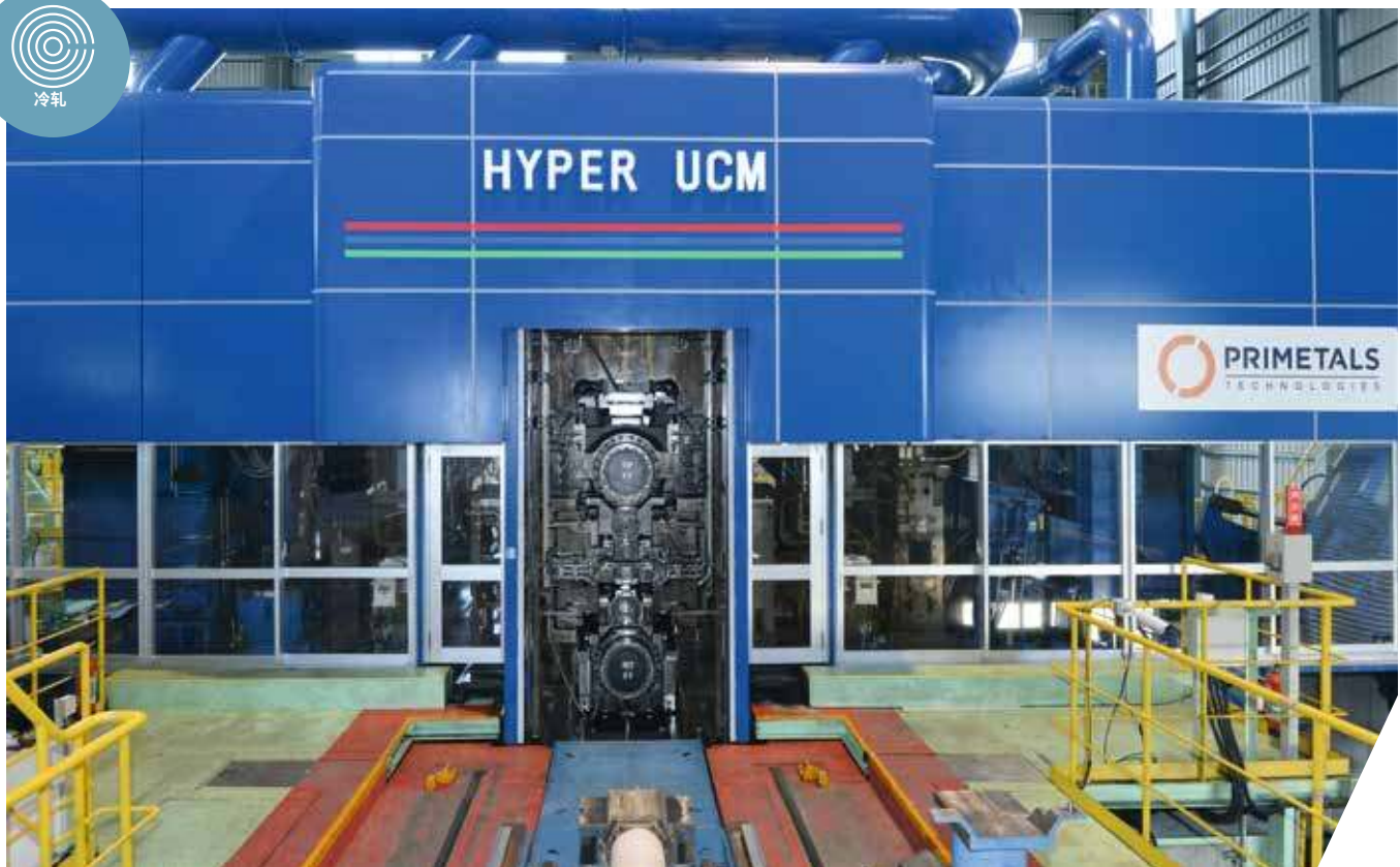
UCMFlat优化普锐特冶金技术万能凸度控制轧机的带钢平直度指标。
