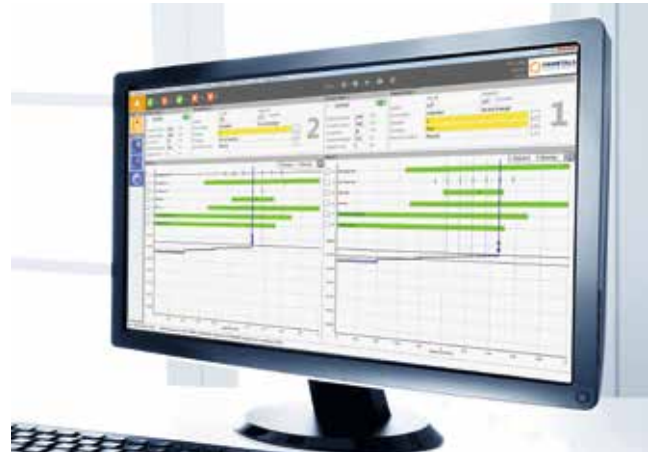
Speed Expert HMI实例。绿条表示满足不同浇铸需要的可接受的拉速范围。
