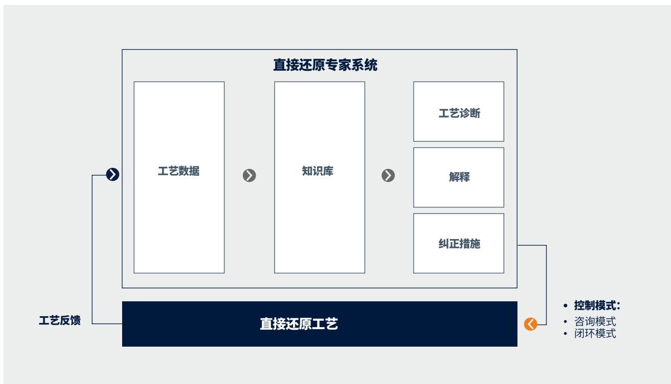
普锐特冶金技术DRIPax直接还原专家系统(2级)的结构。
