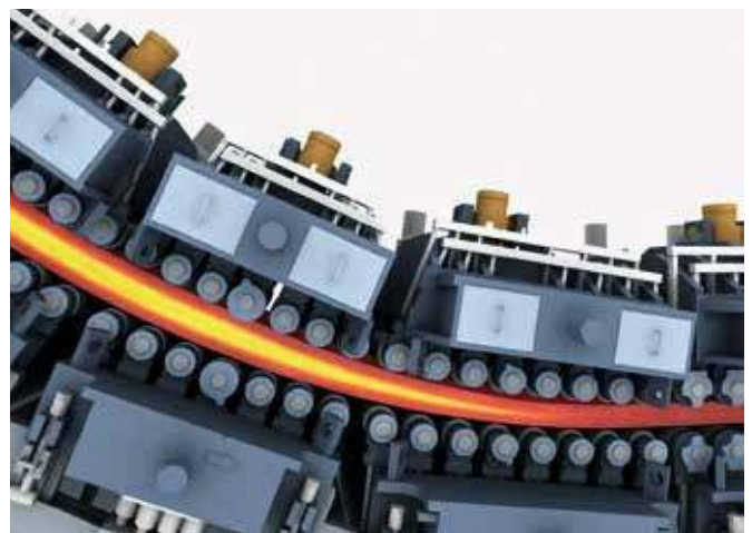
基于DynaGap Soft Reduction 3D的精确辊缝调节能够保证出色的产品质量。
