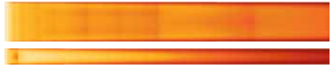
铸流表面温度分布计算结果(顶视图和侧视图)
