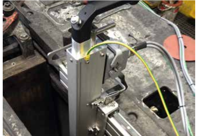
自动热电偶检测器适用于所有类型热电偶,确保优化传感器性能。
