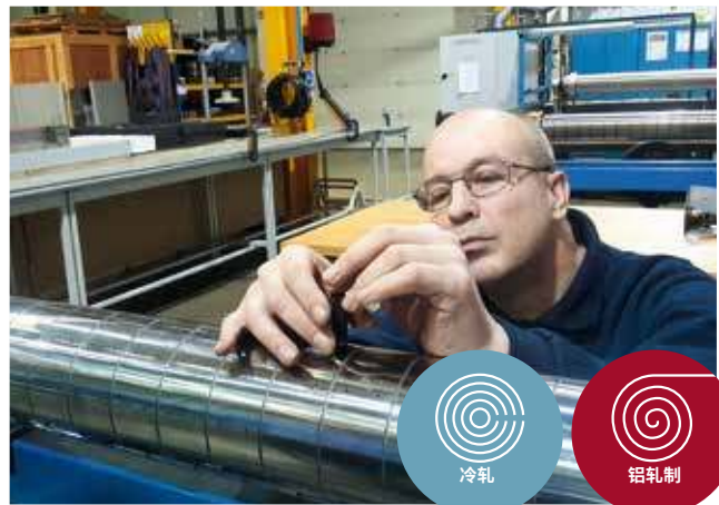
经验丰富的技术人员正在英国克赖斯特彻奇组装精密的空气轴承式板形仪。
