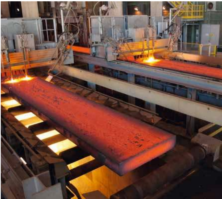
普锐特冶金技术板坯连铸机实例。印度JSW钢铁公司Dolvi厂将安装类似铸机。
